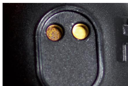
**Kontakte eines Fitnessarmbands nach dem Ladevorgang; der linke Kontakt, zuvor mit Schweißlösung verunreinigt, zeigt eine deutliche Korrosion der Goldschicht im Vergleich zum rechten, nicht verunreinigten Kontakt. Eine Verunreinigung mit chloridhaltigen Lösungen, wie Schweiß oder Meerwasser, bleibt aber im normalen Gebrauch von mobilen Elektrogeräten nicht aus**
