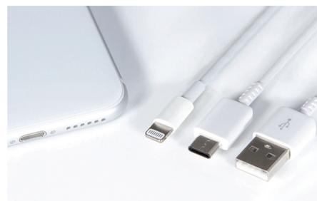
**Durch eine Beschichtung der Kontakte mit RHODUNA® Alloy ist das Basismaterial der Kontakte sowohl am Gerät als auch am Stecker geschützt, wodurch der Ladevorgang sicher und der Fortbestand von Funktionalitäten wie schneller Datentransfer gewährleistet bleiben** (Bild: Umicore Galvanotechnik)
