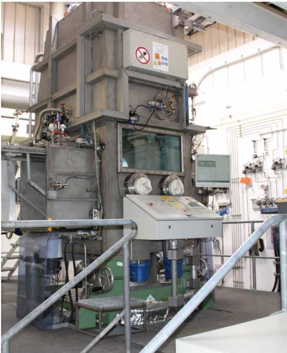
Abb. 6: Umicore Galvanotechnik in Schwäbisch Gmünd beschichtet Anoden mit Hochtemperaturelektrolyse (550 °C); aus der Salzschnmelze kann in einer Argonatmosphäre Platin auf Basismaterialien wie Titan, Niob, Tantal, Molybdän, Wolfram, Edelstähle und Nickellegierungen abgeschieden werden
